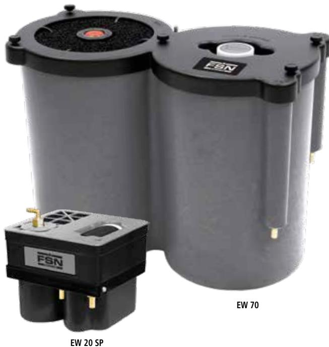
L'EcoWater, con una configurazione a due torri multi-fase, è costituito da un elemento in fibra di polipropilene ed un elemento in carbone attivo, appositamente selezionati e trattati per massimizzare le proprietà adsorbenti, consentendo la massima efficienza di filtrazione.
